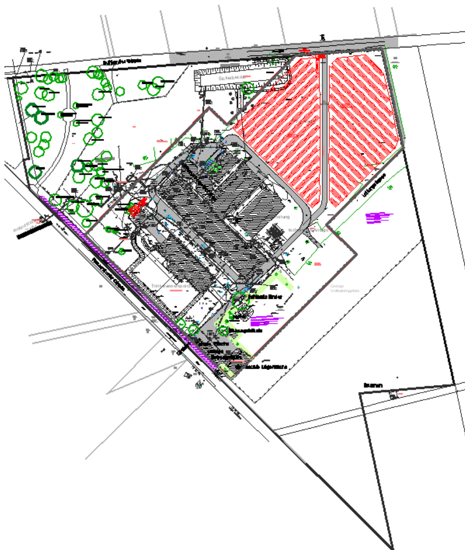
Abbildung 3: Vorhabenplan, o. M., Stand 06.07.2021 Betriebsgebäude des Wasserwerks mit geplanter Photovoltaikanlage einschließlich Nebenanlagen (rot gekennzeichnet)
